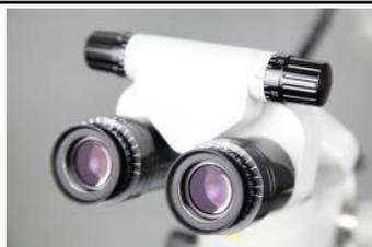
**\*ДОПОЛНИТЕЛЬНОЕ УСТРОЙСТВО РЕГУЛИРОВКИ МЕЖЗРАЧКОВОГО РАССТОЯНИЯ.** ЗАКРЕПЛЕННО НА БИНОКУЛЯРАХ, СЛУЖИТ ДЛЯ РЕГУЛИРОВКИ МЕЖЗРАЧКОВОГО РАССТОЯНИЯ С ПОМОЩЬЮ ВРАЩАЮЩЕЙСЯ РУКОЯТКИ С ДЕЛЕНИЯМИ.
