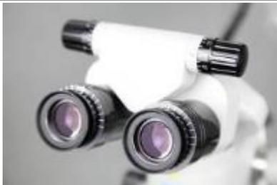
**ДОПОЛНИТЕЛЬНОЕ УСТРОЙСТВО РЕГУЛИРОВКИ МЕЖЗРАЧКОВОГО РАССТОЯНИЯ**. ЗАКРЕПЛЕНО НА БИНОКУЛЯРЕ, СЛУЖИТ ДЛЯ РЕГУЛИРОВКИ МЕЖЗРАЧКОВОГО РАССТОЯНИЯ С ПОМОЩЬЮ ВРАЩАЮЩЕЙСЯ РУКОЯТКИ С ДЕЛЕНИЯМИ.
